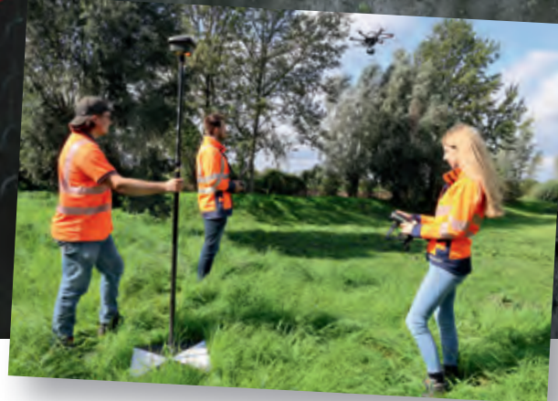
Messung mit Passpunkt, GNSS und Drohne
