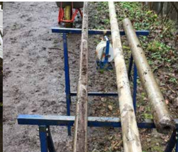
Geotechnische Untersuchungen am HRB Odenkirchen, Bohrkern
